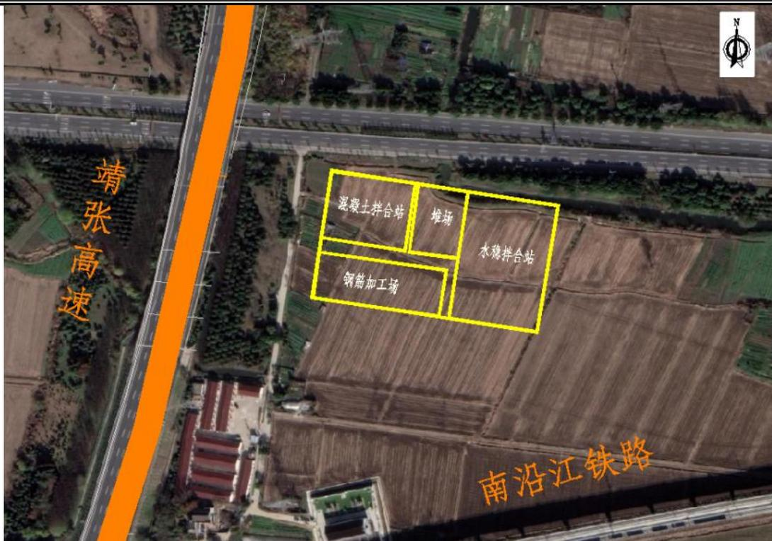
图 2-9 施工场地平面布置示意图
